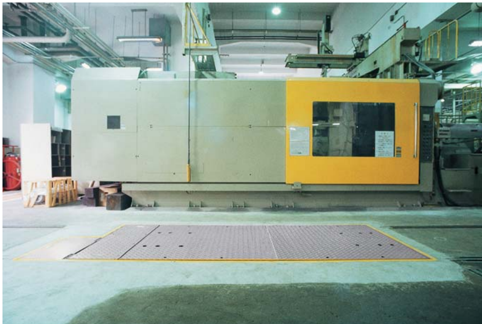
Der SMF kann plan in den Boden eingebettet werden (siehe Foto). Der Tisch ist stabil genug, dass Gabelstapler oder Lkw gefahrlos darüberfahren können.
